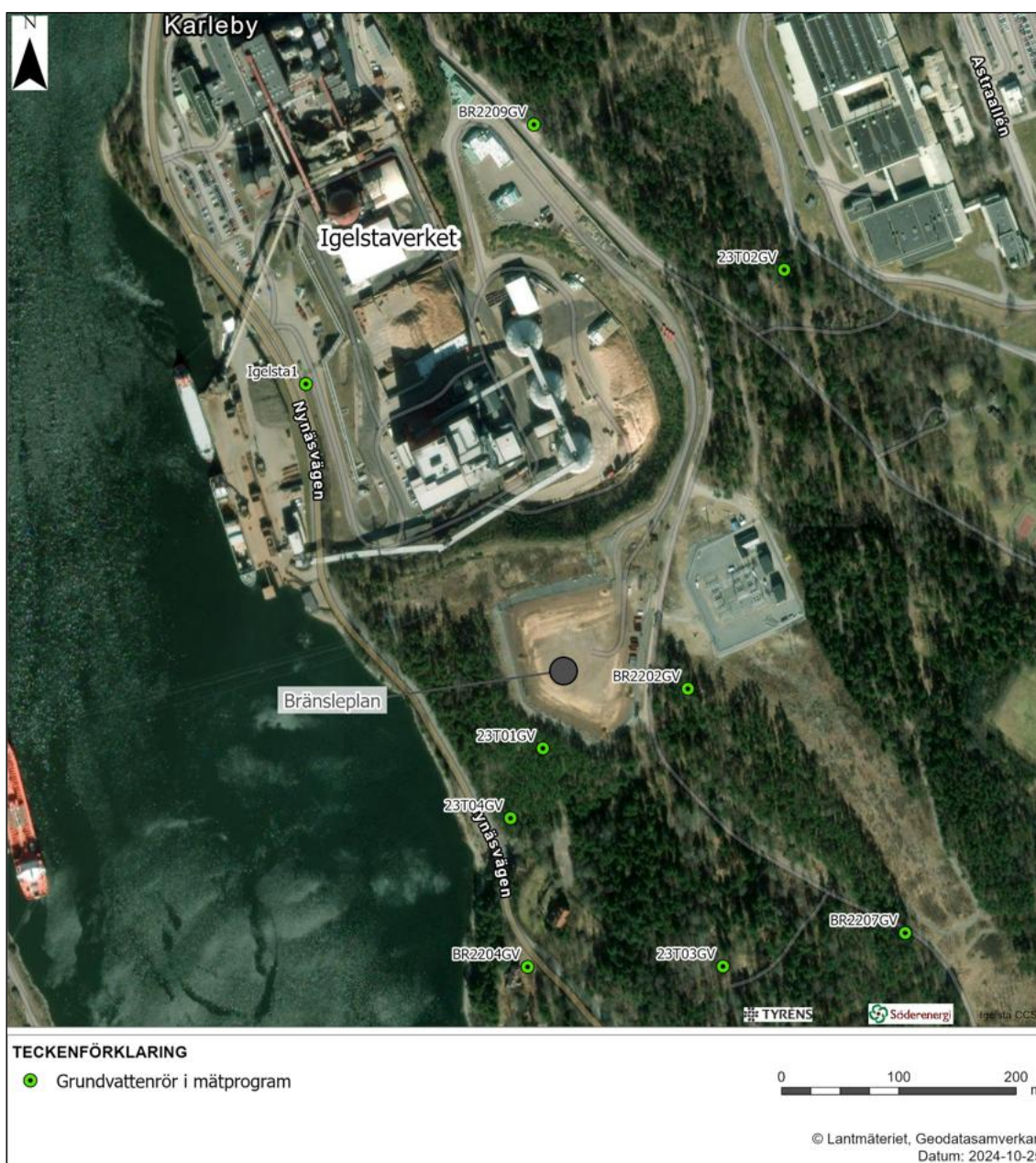
Figur 31: Punkter för grundvattenmätningar (Tyréns 2024)
