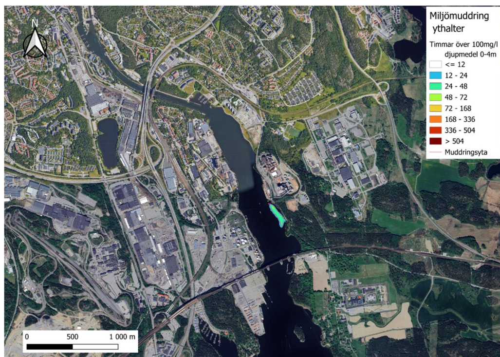
Figur 6.2. Grumling vid miljöuddring av förorenade sediment – antal timmar som grumling beräknas överskrida 20 respektive 100 mg/l. Total tid för miljöuddring bedöms till ca 340 timmar.
