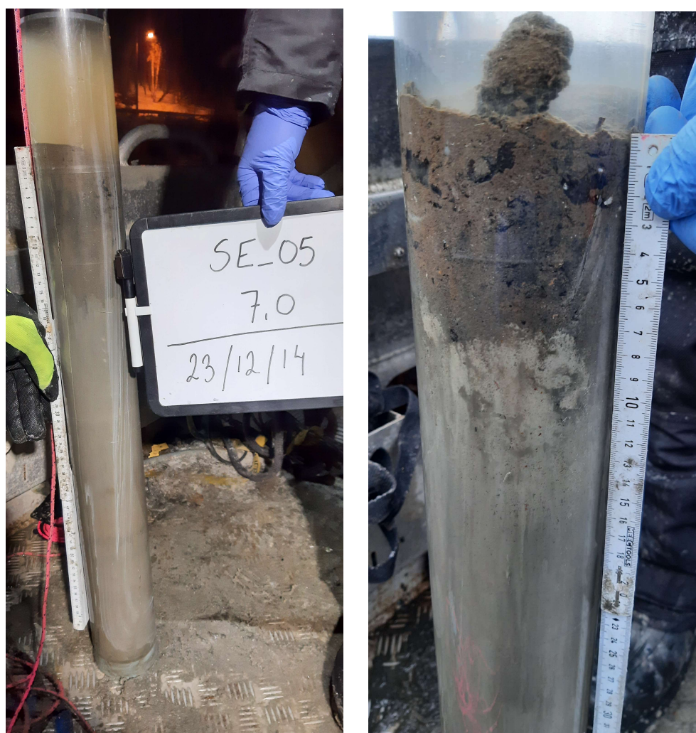
Figur 2. Ostörda sedimentkärnor i plexiglasrör med ett yttigt, mörkare, organiskt lager följt av grå lera. T.v: kärna från provpunkt SE_05, t.h: kärna från provpunkt SE_07.
