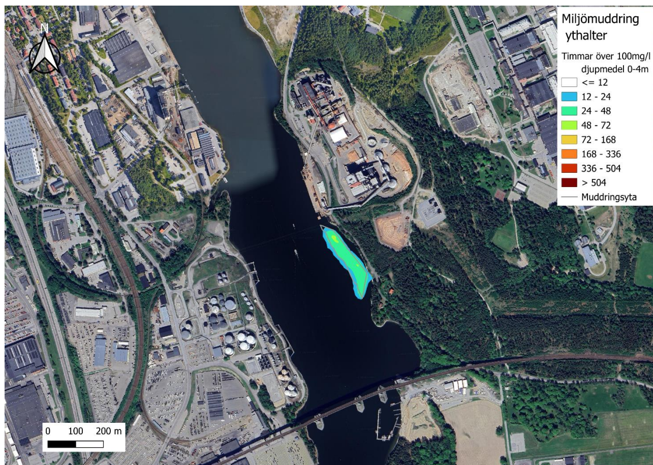
Figur 6.29 Grumling vid miljömuddring i ytan – antal timmar som grumling är beräknad att överskrida 100 mg/l. Total tid för miljömuddring bedöms till ca 384 timmar.
